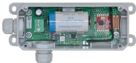
Module embarqué - 2 entrées pour technologie résistive 8,2 kΩ - pile lithium 3,6 V intégrée
