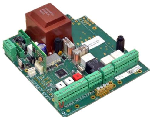
Issue de la dernière génération de cartes PIC 4410 E, cette toute nouvelle PIC 1002 End est dédiée à la fois aux remplacements des anciennes générations de PIC 1002 et aux installations nouvelles. Elle bénéficie de la technologie des nouveaux micro-contrôleurs implantés sur les PIC 4410 E.
