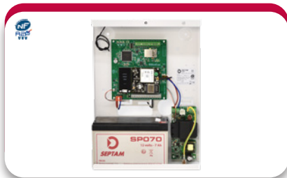
32IP220 DIGICALL en coffret métal avec alimentation 230 Vca/12V 1,6 A
